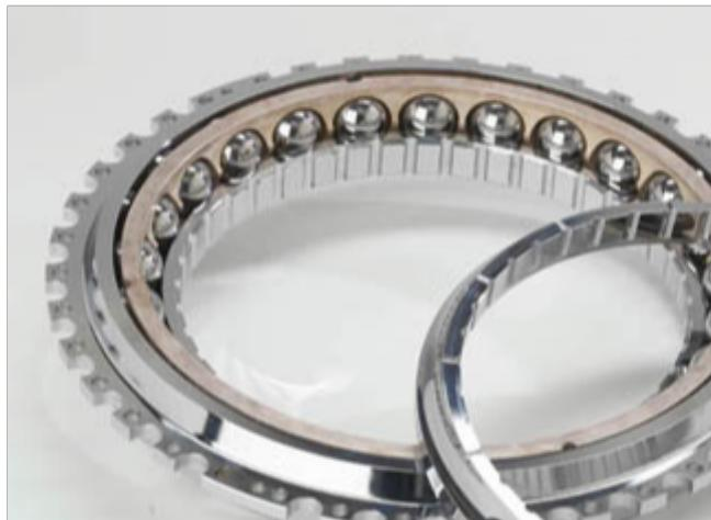
滚动体在轴承中的作用分别是：对于向心轴承，内圈通常与轴紧配合，并与轴一起运转，外圈通常与轴承座或机械壳体孔成过渡配合，起支承作用。但是，在某些场合下，也有外圈运转，内圈固定起支承作用或者内圈、外圈都同时运转的。对于推力轴承，与轴紧配合并一起运动的称轴圈，与轴承座或机械壳体孔成过渡配合并起支承作用的称座圈。滚动体（钢球、滚子或滚针）在轴承内通常借助保持架均匀地排列在两个套圈之间作滚动运动，它的形状、大小和数量直接影响轴承的负荷能力和使用性能。保持架除能将滚动体均匀地分隔开以外，还能起引导滚动体旋转及改善轴承内部润滑性能等作用。江苏铁姆肯轴承种类上海转台轴承经销商。
